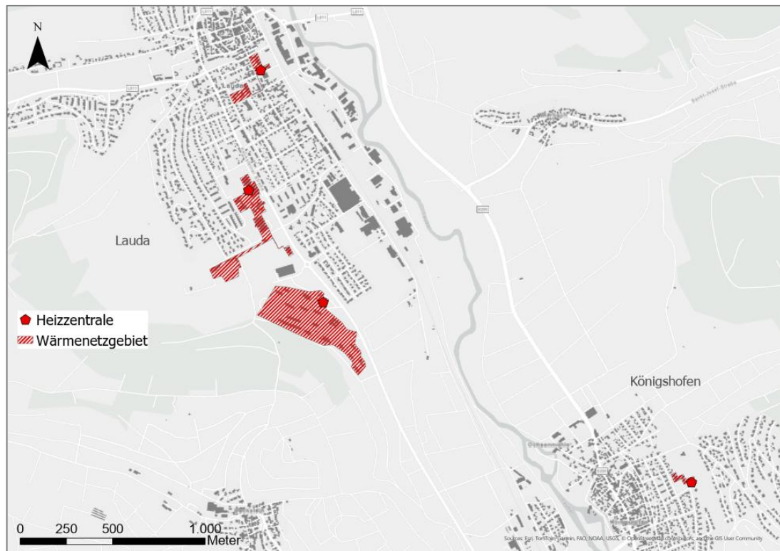
Abbildung 9: Kartografische Darstellung der bestehenden und geplanten Wärmenetze und Heizzentralen
