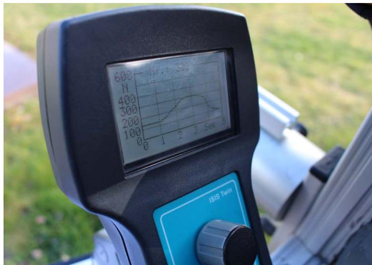
bei dieser Prüfmethode nicht schwanken oder gar umfallen, sondern muss den durch das Gerät ausgeübten Druck standhalten. Diese Prüfmethode ist anerkannt. Die Überprüfung wird nicht durch Hin- und Herrütteln vorgenommen. Eine Beschädigung der Grabmale ist deswegen ausgeschlossen.
